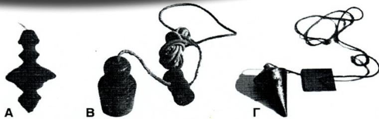
Το ζύγι ή (το) σαούλ(ι), (=το νήμα της στάθμης). – Α': πολύ παλαιό. – Β': νεότερο. – Γ': σύγχρονο. («Αρμολόγ», τχ. 8-9, [Μάης 1980], σ. 35)
